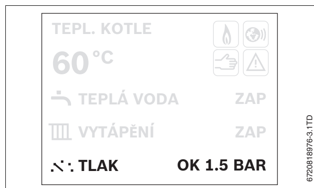
Obr. 5 Odečtení provozního tlaku
